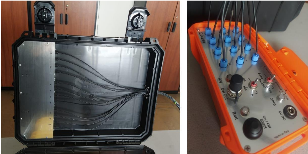
Figura 4: Conexión entre el calibrador y el convertor de señales ópticas a eléctricas.
