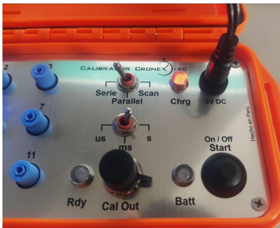
Figura 13: Conexión de cargador de batería.
